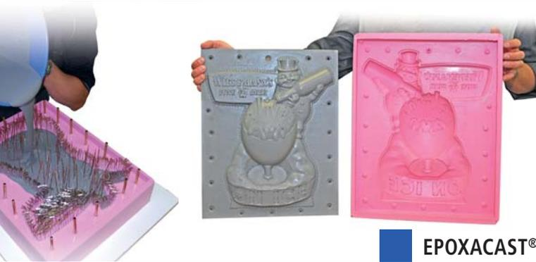
Das aluminiumgefüllte EpoxAcast® 655 verfügt über eine sehr gute Dimensionsstabilität, selbst bei großen Vergussmengen. Es ist wärmeleitend und maschinell bearbeitbar.
