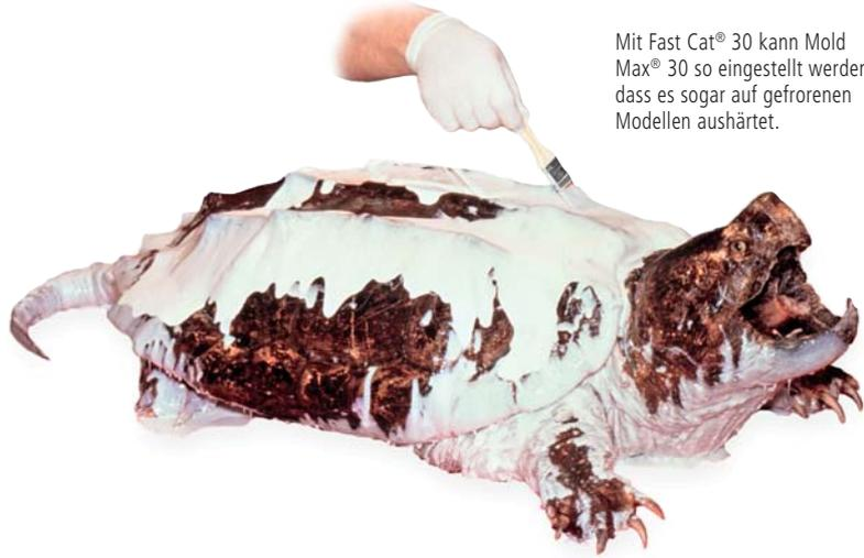
Mit Fast Cat® 30 kann Mold Max® 30 so eingestellt werden, dass es sogar auf gefrorenen Modellen aushärtet.
