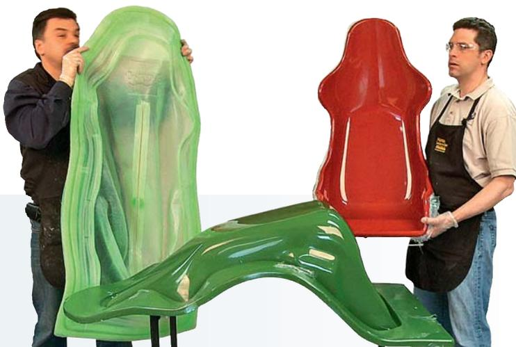
Silikon-Vakuumbaube aus EZ-Spray® Silicone 20 zur Fertigung von Faserverbund Produkten. Hier mit unseren Epoxidharzen EpoxAcoat® Red und EpoxAmite®.
