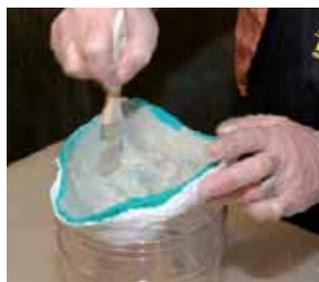
15. Die Negativform kann nun mit zahlreichen Materialien ausgegossen bzw. ausgestrichen werden (hier: *Shell Shock FAST*).
