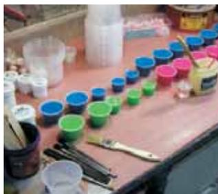
3. Entsprechende Mengen (pro Schicht ca. 200 g) *Body Double FAST & STANDARD* im 1A:1B Volumenverhältnis abmessen und bereitstellen.
