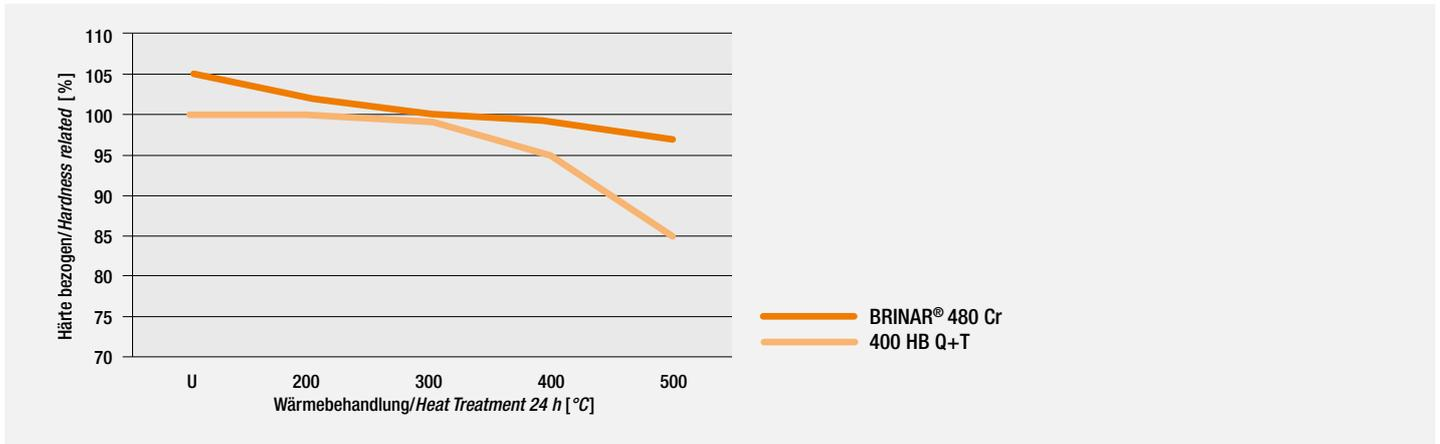
Abb. 1: Härte in Abhängigkeit der Wärmebehandlung
