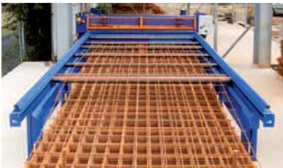
Die Betonstahlmatten werden über das Rollenbett separiert
