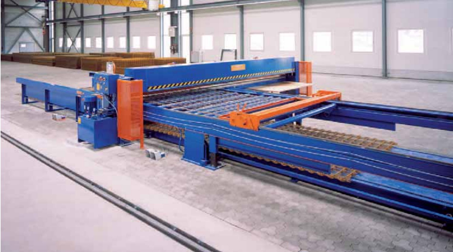
Mattenablegemaschine Mafix A mit Längenanschlag und Kettenlängstransport.
