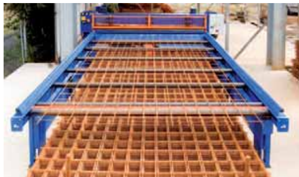
Anschließend werden sie über das Rollenbett mit Fuß-tasterbetrieb durch die Mattenschere hindurch gefahren
