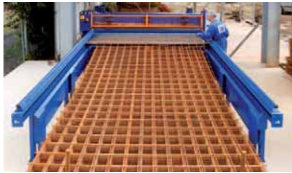
Mafix Z Hubwerk mit 6 kN Hebekraft fördert den Mattenstapel in Arbeitshöhe
