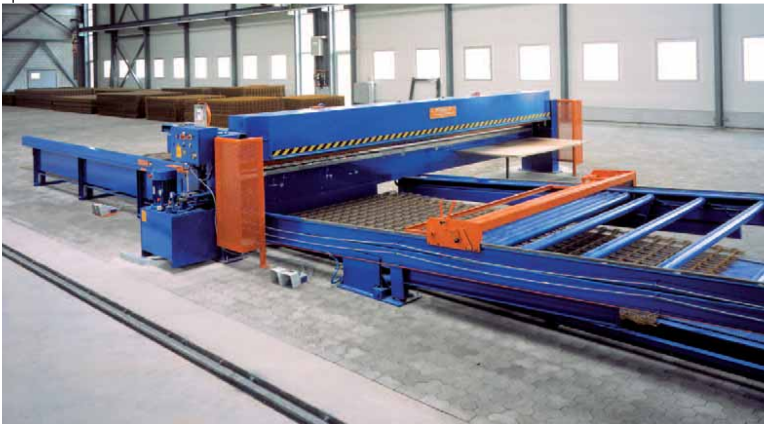
Rahmen mit Rollenbett senkt ab, Rollenbett fährt zurück, geschnittene Matten werden sauber abgelegt und mittels Kettenlängstransport aus dem Ablegebereich in Richtung Mattenbiegemaschine gefördert.
