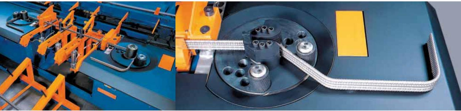
*Permatic Doppelbiegeanlage für automatische Produktion mit nur einem Bediener.*
