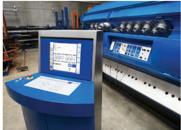
Mit unserer benutzerfreundlichen Software und dem Steuerpult können Sie in Sekundenschnelle Bügelformen auswählen und wechseln.
