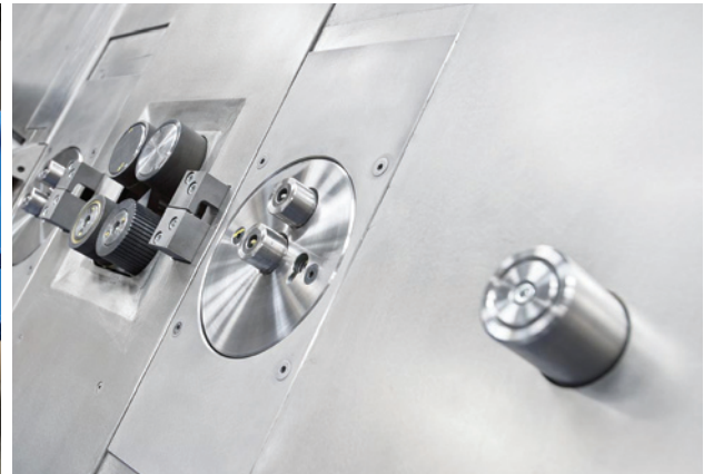
2 Biegeköpfe für Einfach- und Doppelbiegen
