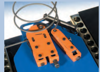
Sondervorrichtung zum Biegen von Ringen, Rundspiralen und großen Bögen // Special device for bending round spirals, rings and large radii
