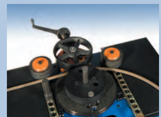
Sondervorrichtung zum Biegen von Ringen und großen Bögen mit Endhaken // Special device for bending large radii and endhooks
