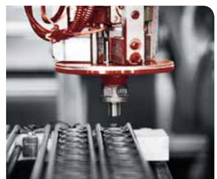
Der Roboterarm entnimmt mit dem Greifer den Rohling aus der Werkstückzuführung ...
