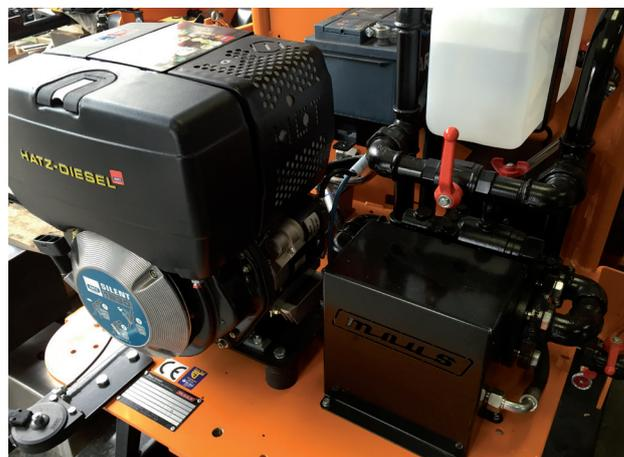
Die beheizte MAUS® Spezial-Kaltbindemittel-Pumpe wird mit einem 5,0 KW HATZ-Dieselmotor hydraulisch angetrieben.
