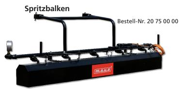
Spritzbalken mit fünf Spritzdüsen. Die Spritzdüsen können einzeln individuell abgestellt werden. Das Öffnen und Schließen erfolgt über ein Schiebegestänge oder optional über einen Wippschalter, der über den Zigarettenanzüder des PKW/LKW einen Elektromotor zum Öffnen und Schließen des Balkens ansteuert. Der Spritzbalken wird an den Rungen befestigt.
