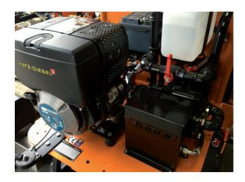
Die <u>beheizte</u> MAUS® Spezial-Kaltbindemittel-Pumpe wird mit einem 5,0 KW HATZ-Dieselmotor mit Elektrostart <u>hydraulisch angetrieben</u>.
