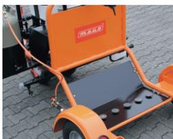
Zu diesem Typ kann eine Fassanwärmevorrichtung, Brenner mit Piezozündung und thermoelektrischer Züandsicherung und Flammüberwachung, geliefert werden, mit der es möglich ist, besonders zähflüssige Bindemittel auf ca. 35-40 C° zu erwärmen und somit einwandfrei zu verarbeiten.
