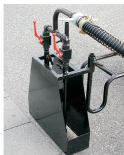
Um ein Verschmutzen des Randsteines o.ä. zu vermeiden, haben wir eine höhenverstellbare Kantenspritzvorrichtung mit Spezialdüsen entwickelt. Dieses Gerät wird seitlich an unseren Maschinen angebracht und garantiert einwandfreie Kantenspritzungen.
