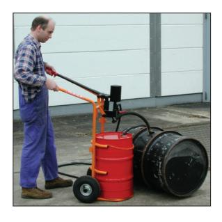
Mit diesem Gerät bzw. mit der Pumpe kann das Bindemittel aus einem 200 l Fass in das kleine 50 l Fass ohne Mühe umgepumpt werden.
