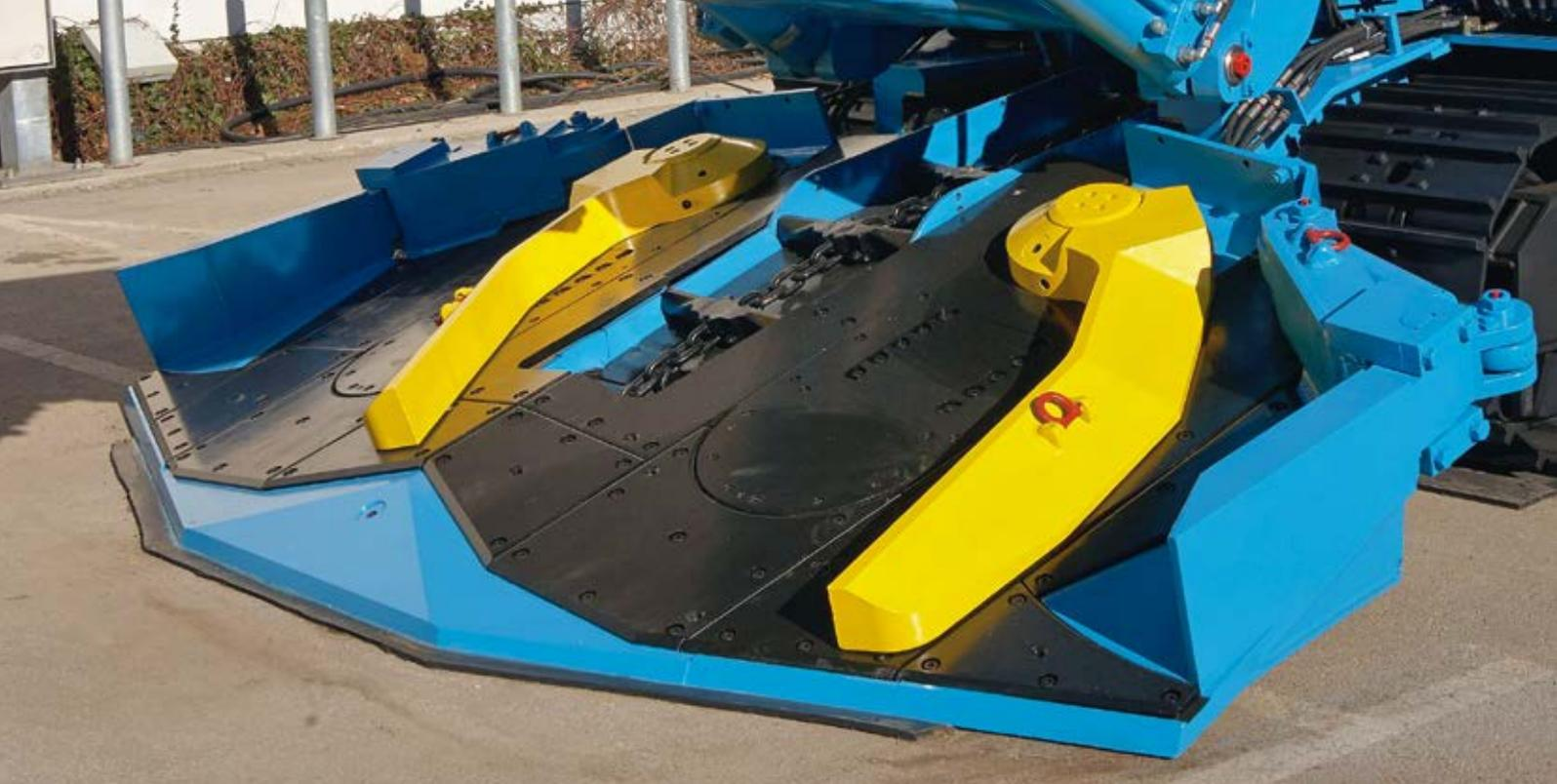
*Das robuste Ladesystem mit Räumbalken führt das Haufwerk dem Mittelförderer zu.
