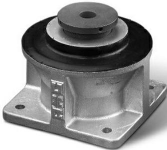
Les cônes avec base AMC-Mecanocaucho® travaillent l'élastomère en compression-cisaillement. Ils sont constitués d'une armature extérieure métallique hautement résistante et d'une armature conique interne concentrique. Pour faciliter l'installation, ils disposent d'une base avec des trous de fixation au châssis.
