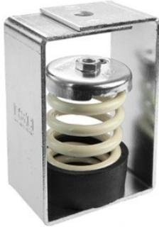
Fréquence de résonance de 5 Hz jusqu'à 3 Hz. C'est une gamme conçue pour la suspension des faux plafonds acoustiques et machines travaillant à partir de 450 tr/min. Elle est fabriquée avec un ressort de grande performance mécanique. Ils incorporent une rondelle de caoutchouc pour éviter les "ponts acoustiques" et le contact d'une cheville non alignée. La structure métallique est résistante et la surface d'une couche électrolytique bichromatée.
