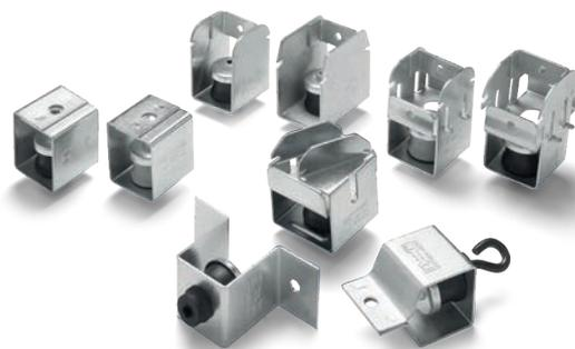
Gama diseñada para la suspensión de falsos techos acústicos y maquinaria trabajando a partir de 1.000 r.p.m. En toda la gama Akustik se mantiene el mismo elemento antivibratorio fabricado en caucho de gran calidad mecánica, especialmente diseñado para el aislamiento vibratorio. La estructura metálica es resistente a más de 650 kg y recubierta de baño zincado trivalente.
