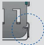
1• El sistema de seguridad se adapta a perfiles de diferentes anchuras.
