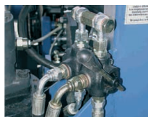
Leve comando velocità motori Motor speed control levers
