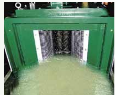
Zařízení Double Drum Channel Monster - poskytují vysoký průtok a usměrňují pevné látky do drtiče.
