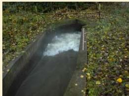
Bei zu hohen Fließgeschwindigkeiten können störende Wirbel auftreten. Bei zu wenig wird das Messsignals so gering, dass es leicht zu stören ist.
