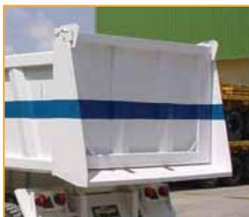
Caisse équipée d'un déversoir arrière qui garantit un déchargement maximisé et assure une plus grande sécurité.
