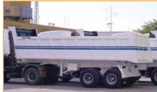
Châssis mécano-soudé offrant une très grande souplesse et stabilité. Fortement conseillé par les constructeurs de tracteur.
