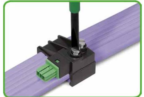
Contact avec le câble plat par serrage des vis. (Couple de serrage 1 Nm)
