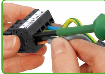
Actionner le ressort de serrage à l'aide d'un tournevis dont la largeur de lame est de 5,5 mm et introduire le fil dénudé jusqu'en butée pour raccorder des conducteurs souples.
