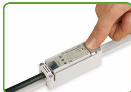
Faire glisser la partie supérieure sur la partie inférieure jusqu'à être en butée et la faire encliqueter. Presser le levier vers le bas et le verrouiller. Le contact des 3 connecteurs se réalise simultanément.
