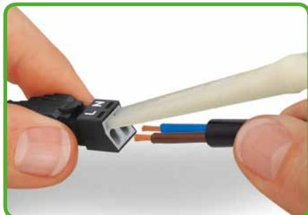
Pour le raccordement des conducteurs souples, ouvrir les deux ressorts de serrage à l'aide de l'outil de manipulation 890-392 et introduire le fil dénudé jusqu'en butée. La connexion des conducteurs rigides se réalise par enfichage direct.
