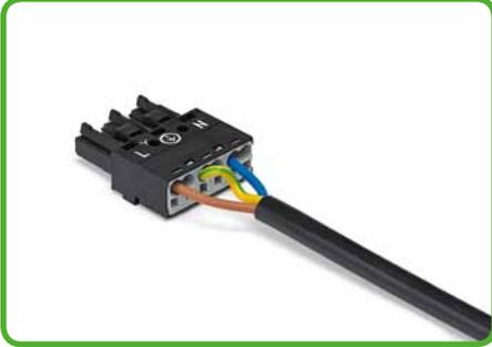
Actionner le ressort de serrage à l'aide d'un tournevis dont la largeur de lame est de 2,5 mm et introduire le fil dénudé jusqu'en butée pour raccorder des conducteurs souples. La connexion des conducteurs rigides se réalise par enfichage direct.
