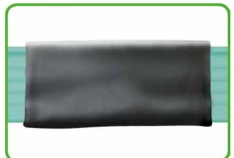
Après la suppression d'un module, il faut réparer le câble plat avec du ruban isolant.
