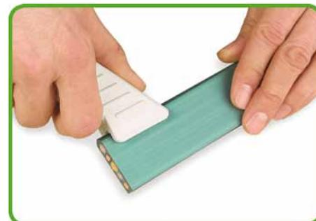
Ouvrir la gaine du câble plat à l'aide d'un couteau de dégainage sur les deux côtés (longueur de dégainage 30 mm).
