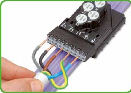
Connexion d'un câble dégainé au module d'alimentation. Les conducteurs rigides dénudés peuvent être enfilés directement. Pour les conducteurs souples dénudés, les points de serrage doivent être préalablement ouverts à l'aide d'un tournevis.
