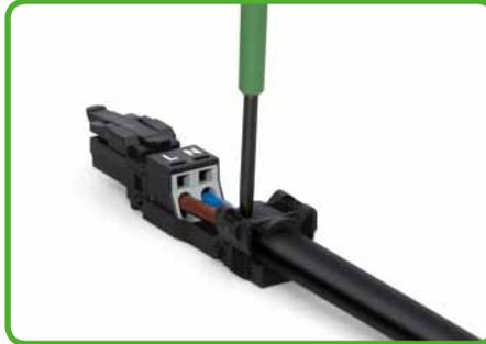
Presser l'étrier de décharge de traction à l'aide d'un tournevis (largeur de la lame 2,5 mm) sur les deux côtés.
