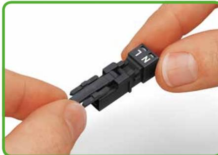
Des cliquets de verrouillage sont montés en usine sur tous les composants prévus à une installation fixe (connecteurs encastrables pour luminaires, appareils et distributeurs) de sorte que ces composants soient toujours verrouillés avec les connecteurs femelles ou mâles à enficher. Un cliquet de verrouillage supplémentaire est nécessaire uniquement dans le cas d'une « connexion volante » (mâle/femelle).
