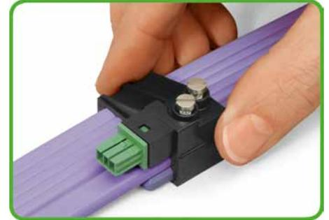
Le montage du module IDC sur la partie inférieure est seulement possible, si le codage est approprié. Si le codage du module IDC se bloque par rapport à la partie inférieure, il faut retourner le module de 180° et le monter jusqu'à ce que les deux composants soient bord à bord.
