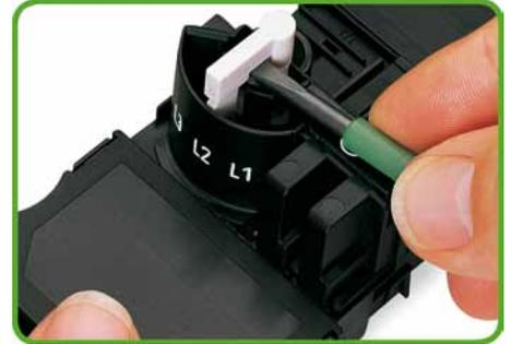
Soulever le sélecteur de phase placé en position d'alimentation L2 à l'aide d'un tournevis et le faire pivoter sur la phase désirée.
