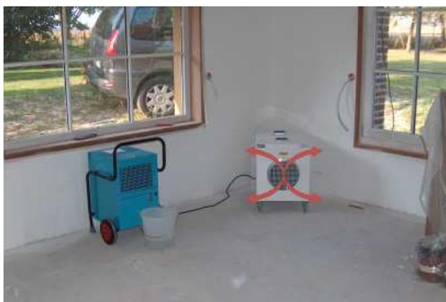
Le chauffage C9 Kw est équipé d'une seule turbine contre 2 pour le modèle C18 kw.
