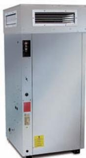
Die Kältetrockner saugen die feuchte Umgebungsluft an und kühlen diese unter ihren Taupunkt, wodurch ein Großteil der luftgebundenen Feuchtigkeit kondensiert und der Luft entzogen werden kann. Das Kondensat wird abgeführt und die trockene kalte Luft am Wärmeteil des Kälteblocks vorbeigeleitet, dort durch die freige-wordene Prozessenergie erwärmt und dann der Raumluft wieder zugeführt.
