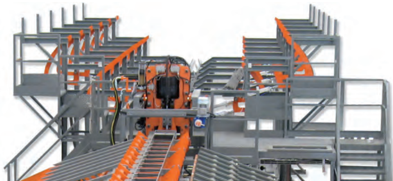
1. FA: Секционный склад служит для накопления и загрузки прутьев.
