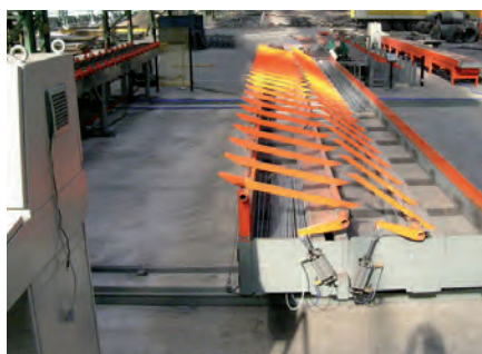
6. CPO: Фронтально перемещающийся по рельсам накопитель. Служит для промежуточного накопления и перемещения пучков прутьев, порезанных в размер.
