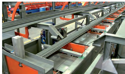
2. VA: Система предварительного секционного хранения с вращающимися плечами на подающем конвейере.
