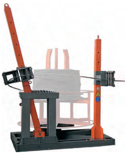
Разматыватель мод. MPO Base for pay-off mod. MPO (3,5 T) Base aspo mod. MPO Haspelrahmen Typ MPO
