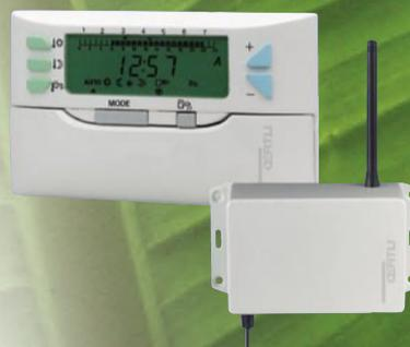
La régulation d'ambiance, raccordement par 2 fils (AD 223) ou version radio (AD 224) : la température de la chaudière varie en fonction de la consigne d'ambiance. Le rajout d'une sonde extérieure permettra d'affiner le calcul de la température de chauffage.
