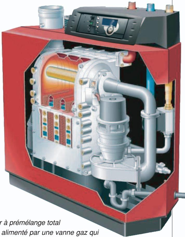
Eléments en fonte d'aluminium-silicium Al-Si, robustes et d'une grande longévité
