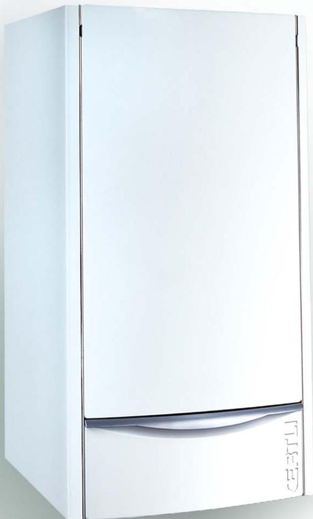
*Les fumées générées par la combustion du gaz ont une forte teneur en vapeur d'eau. La technique de la condensation permet de récupérer la chaleur contenue dans la vapeur d'eau et de l'ajouter à la chaleur de combustion. La chaudière à condensation a ainsi un rendement bien supérieur à celui des chaudières classiques et permet de réaliser des économies d'énergie appréciables.*
