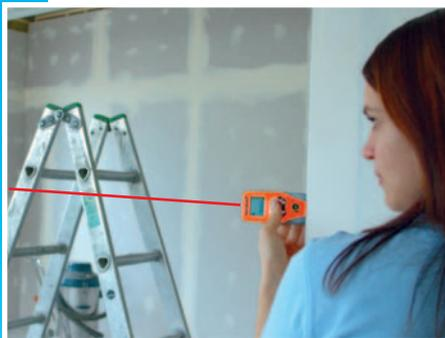
Mesures rapides et au millimètre près sur des distances allant jusqu'à 30 m.
