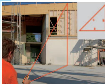
Détermination de hauteurs inaccessibles à l'aide de la fonction Pythagore.
