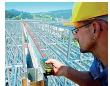
Le détecteur de cible numérique intégré avec zoom 4 x permet même la mesure simple et précise de grandes distances à l'extérieur.
