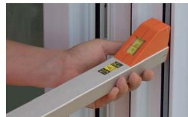
Le **mEssfix Nedo** avec pointes pour volets roulants permet la mesure à partir des glissières du volet.
