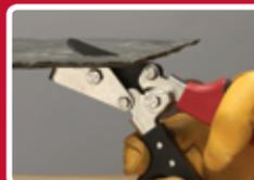
Les mâchoires dentelées supérieures agrippent la partie arrière de l'ardoise pour une découpe antidérapante contrôlée.
