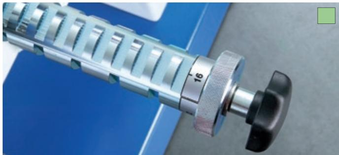
Dispositif de perçage pour chevilles (écartement 16, 22, 25, 32 mm) pour le perçage rapide de séries de trous.
