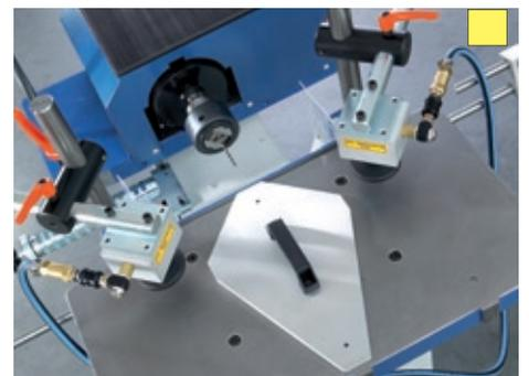
Serrage pneumatique avec clapet manuel sur le cylindre.
