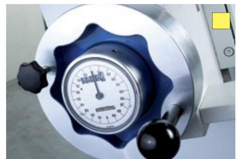
Afficheur gradué au 1/10e dans le volant pour le réglage en hauteur.
