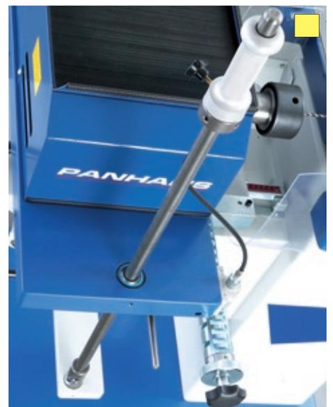
Un levier de commande permet la sélection et la progression sans effort des entraxes de perçage sur l'arbre cannelé.
