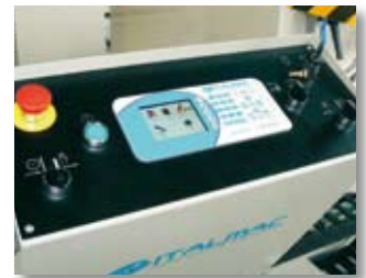
Version avec positionneur, écran graphique 3,5" TFT pouces à couleurs (320x240 pixels), mémoire RAM 512 MB.
