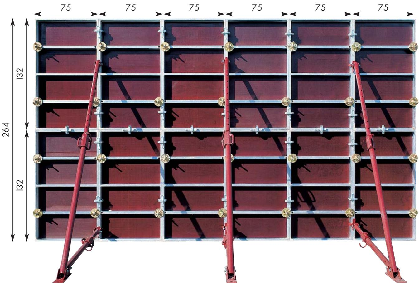
Assemblage des éléments DUALU pour coffrer un voile de 2,64 m. Les diverses combinaisons modulables permettent d'atteindre les hauteurs suivantes : 1,32 ; 2,07 ; 2,64 ; 3,39 ; 3,96 m.
