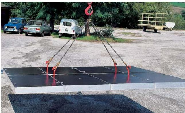
Une fois le plateau retourné, les crochets grue sont démontés et la manutention se fait par l'intermédiaire des 4 anneaux.
