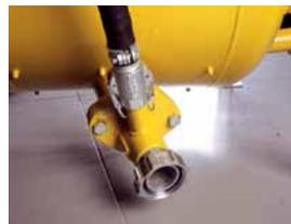
Sortie cuve avec raccord à vis
