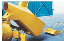
Benne de chargement avec pelle tractée
