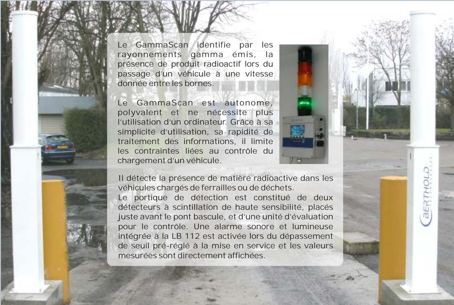
Le GammaScan identifie par les rayonnements gamma émis, la présence de produit radioactif lors du passage d'un véhicule à une vitesse donnée entre les bornes.
