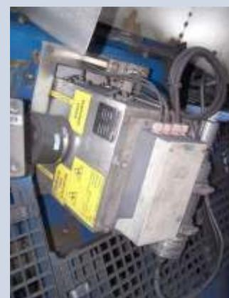
La valeur d'humidité est déterminée par la teneur en hydrogène dans un grand volume de produit. La variation de pH ou de concentration de composants électrolytiques dans le produit n'affecte pas le principe de mesure.
