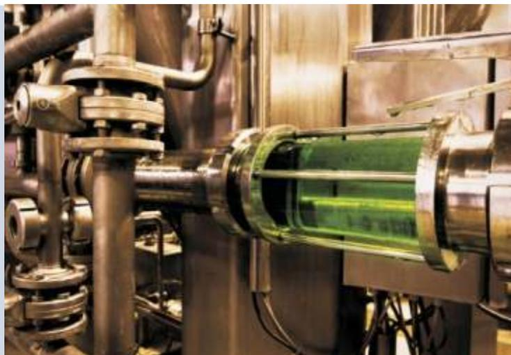
L'appareil mesure la totalité du produit passant dans la conduite principale ou en dérivation. Les mesures directes ainsi obtenues par la technologie micro-ondes sont des valeurs représentatives pour le contrôle qualité et l'optimisation du process.
