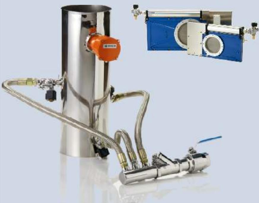
Pour des produits pulvérulents en transports pneumatiques ou pour des produits en chute, l'injection sous haute pression de grosses gouttes d'eau sous forme de puissants jets d'eau conique, est la solution adaptée pour bien pénétrer le flux de matière.
