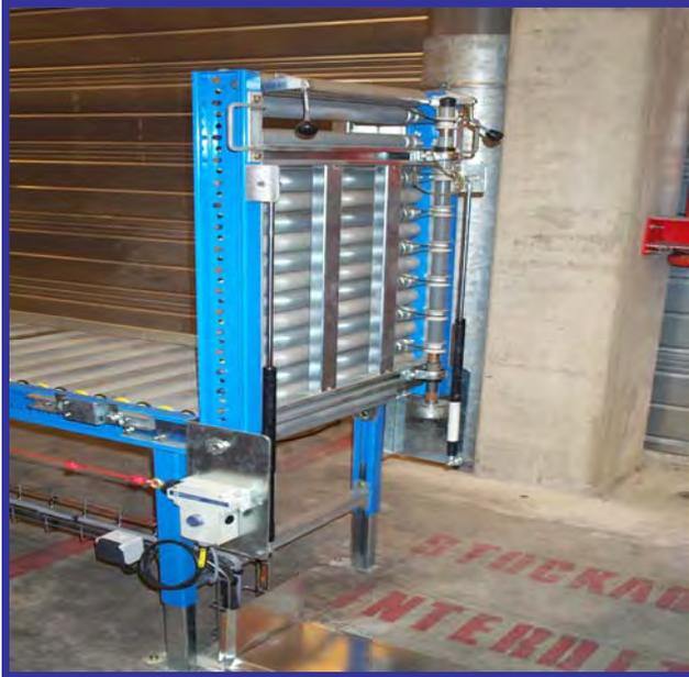
Le transporteur à rouleaux motorisés par courroie ronde portillon permet un accès opérateur occasionnel.
