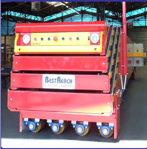
La translation motorisée autonome est une configuration permettant au convoyeur télescopique à bande d'effectuer un mouvement transversal sans rails au sol.
