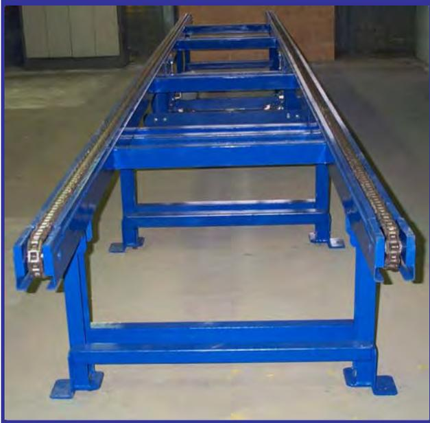
Le transporteur Bi-Châînes est utilisé pour le transport de charges qui ne peuvent être transités par un convoyeur à rouleaux.
