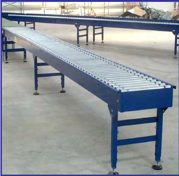
Le transporteur à rouleaux motorisés par courroie ronde est un transporteur d'accumulation à faible pression de frottement
