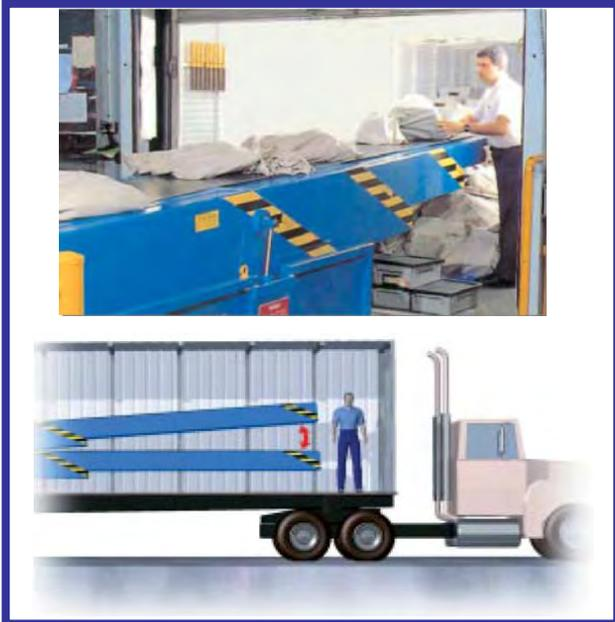
L'ajout d'un dispositif d'inclinaison hydraulique améliore l'ergonomie et rend plus facile la manutention manuelles des charges aux différents endroits de la zone de travail.
