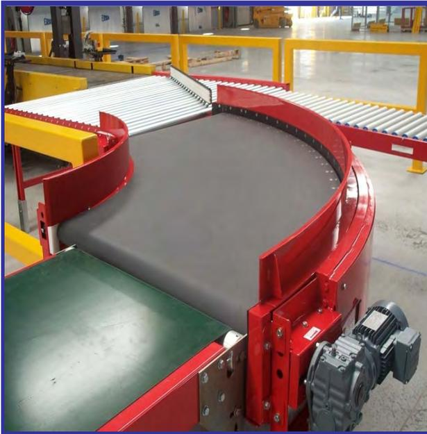
Permettant de transporter des charges inégales aussi bien par leur forme que par leur poids, elle est couramment utilisée en complément de convoyeurs droits à rouleaux ou à bande.
