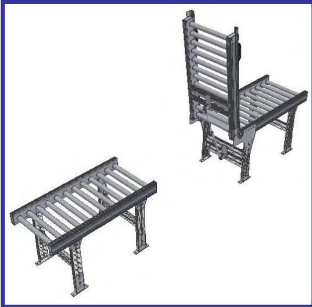
Le transporteur portillon à rouleaux libres permet d'offrir en milieu de ligne de convoyage un passage d'opérateur ou de chariots de manutention.
