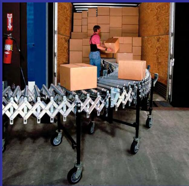
Le transporteur extensible à rouleaux motorisés est utilisé comme solution de chargement/déchargement pour de véhicules, crossdocking ou linking.
