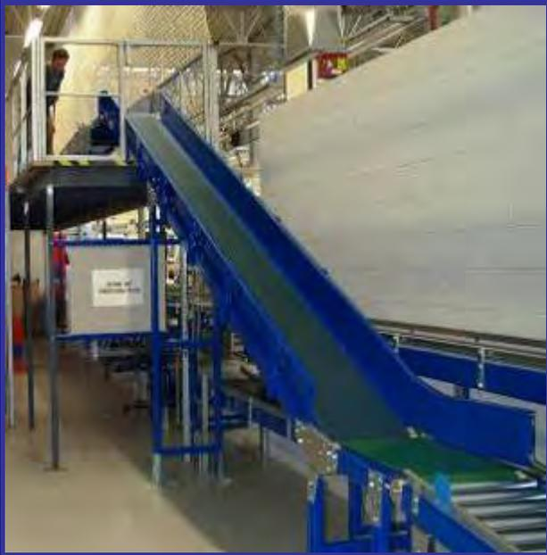
Le transporteur à bande élévateur/descenseur est utilisé où le changement de niveau est nécessaire.
