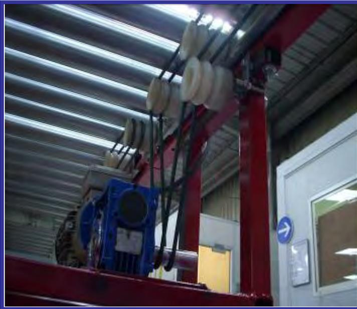
Le nouveau système EP2C breveté simplifie la motorisation des tables à rouleaux et la rend ultra performante. Vous n'avez plus besoin d'appeler un technicien et de mettre à l'arrêt votre installation une demi-journée ou plus. La technologie « EP2C » permet la motorisation de vos convoyeurs à rouleaux libres existant.
