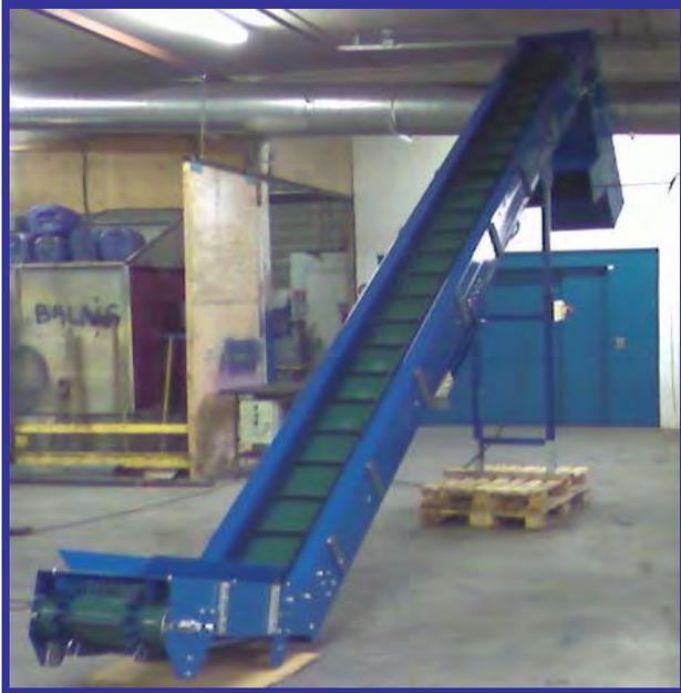
Le transporteur à bande col de cygne permet le transport de nombreux types de produits tels que granulats et produits en vrac.
