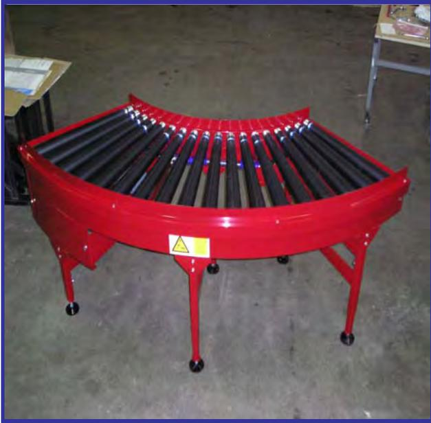
Le transporteur à rouleaux motorisés par courroie ronde courbe est utilisé pour changement de direction du transport des produits.
