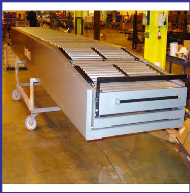
Le transporteur télescopique est un outil dédié uniquement au chargement de véhicules pour les charges isolées.
