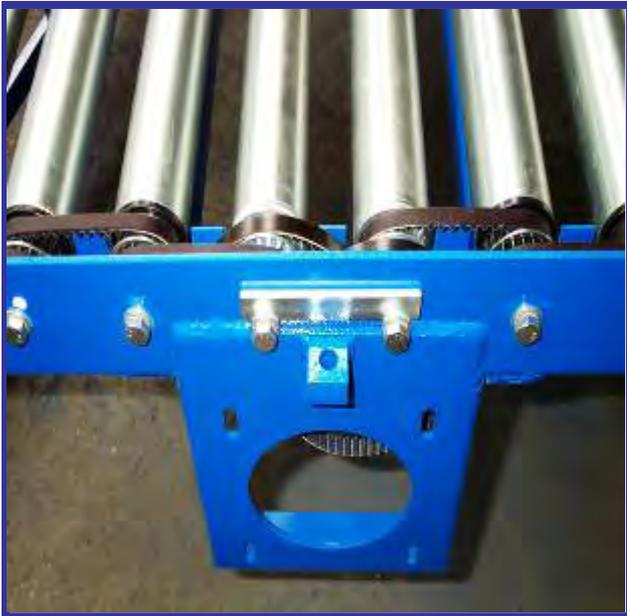
Le transporteur à rouleaux motorisés par pignon doubles courroies crantées utilisent des courroies fermées comme moyen d'entraînement.
