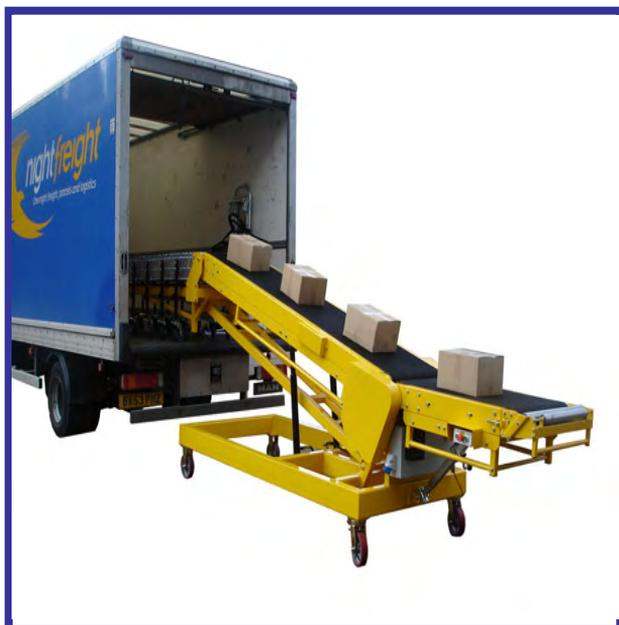
Le chargeur économique est un convoyeur incliné à double bande pour chargement/déchargement des cartons dans les entrepôts n'ayant pas de quai.
