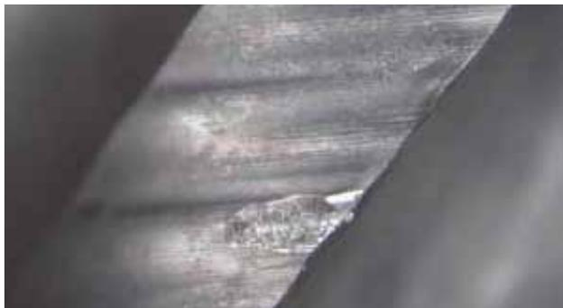
Illustration d'usure d'une fraise d'ébauche traditionnelle après 17 minutes d'utilisation dans la matière 42CD4. Les ruptures sur les éminences du profil provoquent une fin prématurée du temps d'intervention. La possibilité de réaffûtage est alors remise en question.
