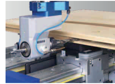
10 HSK F63 Agrégat d'inclinaison à 1 sortie avec 1 connexion WELDON pour outil de perçage, fraisage ou sciage maxi. Ø 240 mm Nr. Réf. 300-24-020
