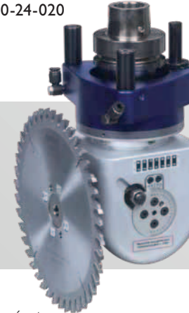
10 HSK F63 Agrégat d'inclinaison à 1 sortie avec 1 connexion WELDON pour outil de perçage, fraisage ou sciage maxi. Ø 240 mm Nr. Réf. 300-24-020
