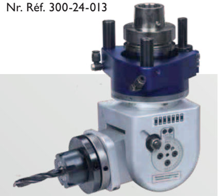
11 HSK F63 Agrégat d'inclinaison à 1 sortie avec connexion ER 25 pour outil de perçage, fraisage ou sciage maxi. Ø 240 mm Nr. Réf. 300-24-013
