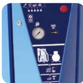
Panneau de contrôle centralisé avec indication de pression et rappel des opérations de maintenance.
