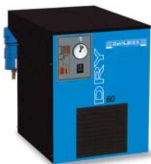
Dans la version **COMPLET** l'équipement comprend un sécheur par réfrigération. L'air comprimé est parfaitement déshumidifié (grâce à un point de rosée de +5°) et filtré par deux filtres (un anti-poussière 3 µm, un déshuileur submicronique 0,01 µm)
