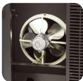
Système de refroidissement du compresseur comprenant un électroventilateur indépendant équipé de grandes pales et thermostaté, fonctionnant encore après l'arrêt du compresseur ( pour les modèles 7,5 et 10 CV uniquement).
