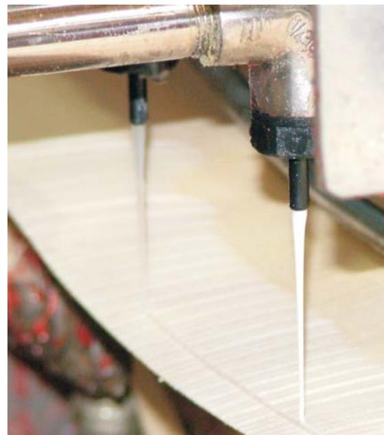
El equipo es activado automáticamente mediante el fotosensor cuando éste detecta la chapa, con retraso ajustable, la cola y el endurecedor son aplicadas por separado directamente sobre la chapa a través de las boquillas.
