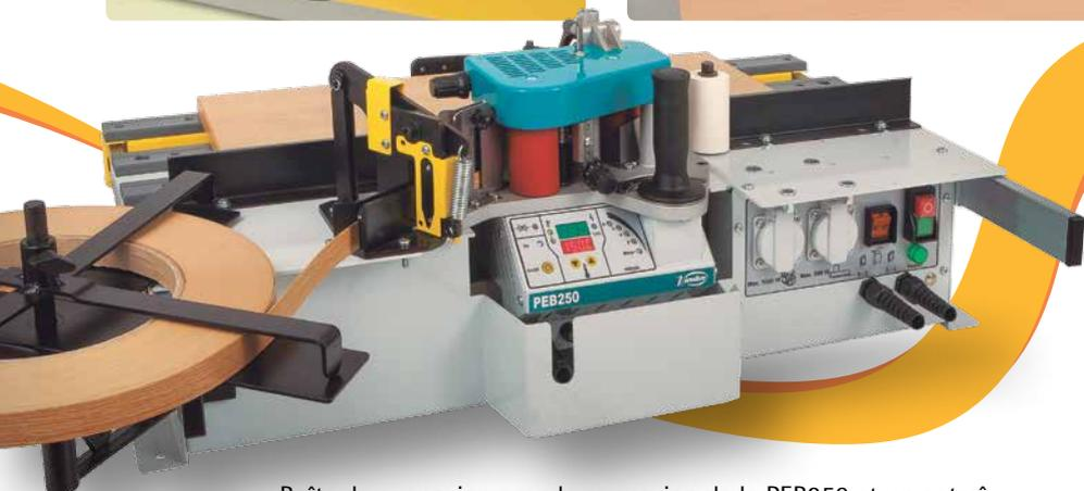
Boîte de connexion pour la connexion de la PEB250 et un entraîneur de panneaux. La table est équipée des trous pour sa fixation.
