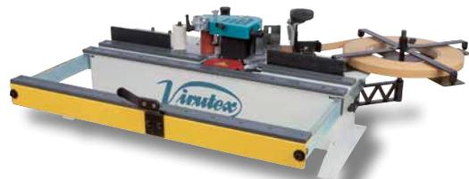
PEB250TRC avec réglage électronique de la vitesse et la température.
