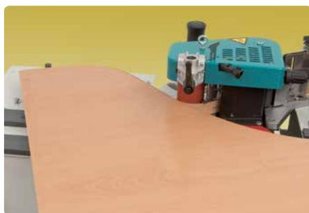
Coupe en arrière automatique. Avec pédale de commande pour des pièces courbes.
