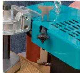
Anneau pour fixer la machine à un système suspension. Pour faciliter les travaux à longue durée.
