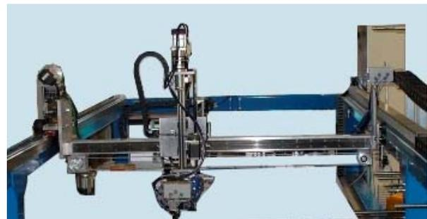
Per contenere gli ingombri della macchina, l'asse verticale Z, può essere telescopico (per corse > di 1500, 1800mm).
