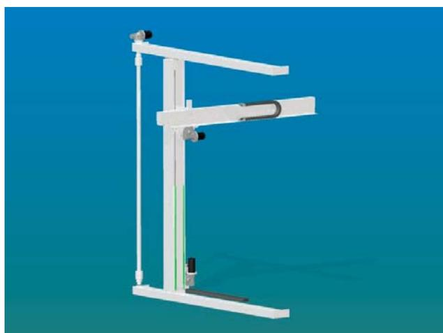
La figura a fianco è un robot cartesiano a 2 assi con 2 assi rotativi U e W utilizzato per verniciatura. L'asse verticale è un modulo Y mentre l'asse trasversale è un modulo ZC
