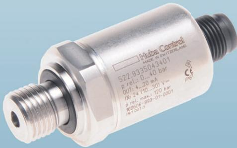
Les transmetteurs de pression type 522 pour l'industrie marine sont basés sur la technologie à couche épaisse développée par Huba Control. La cellule est soudée au raccord de pression et ne nécessite pas de joint d'étanchéité.
