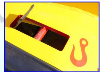
Anneau pour hissage Lifting ring
