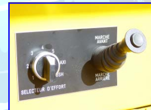
Sélecteur d'effort au crochet de 1000 à 3000 kg Hooking capacity selector
