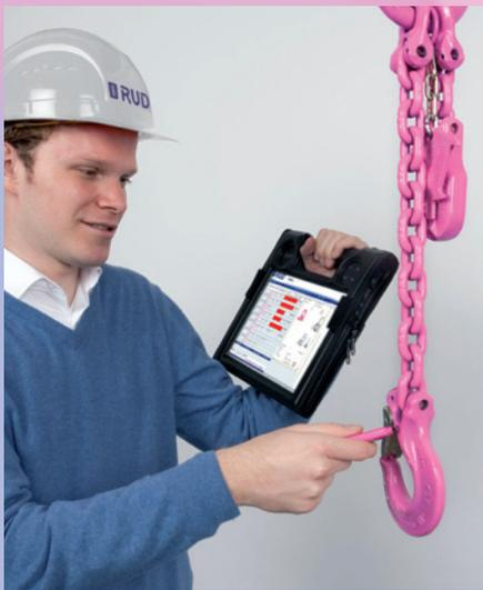
Les contrôles périodiques des accessoires de levage (imposés par le code du travail et les directives associés) sont encore trop compliqués et sujets à de nombreuses erreurs.
