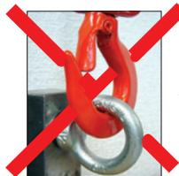
Chargement uniquement dans un intervalle d'angle de fixation vraiment très restreint (jusqu'à 45° de la verticale et uniquement dans le plan de l'anneau). Tout pivotement, toute rotation de la charge entraîne une rotation de l'anneau ➔ aucune maîtrise, aucun soutien ➔ **travail en flexion, cisaillement, concentration de la charge sur la vis, danger de rupture !**
