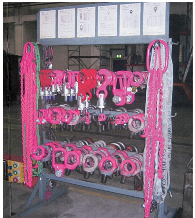
Stockage correct des anneaux de levage et élingages !
