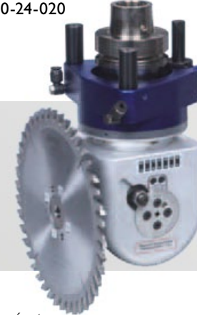
9 HSK F63 Agrégat d'inclinaison à 1 sortie avec 1 connexion WELDON pour outil de perçage, fraisage ou sciage maxi. Ø 240 mm Nr. Réf. 300-24-020
