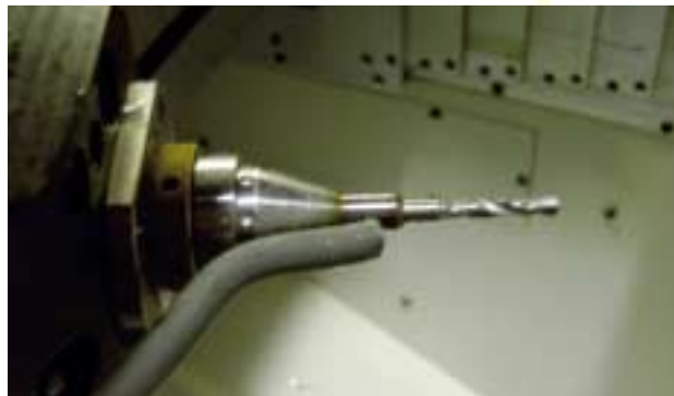
Interface HSK et porte outil à fretter de type Marquardt
