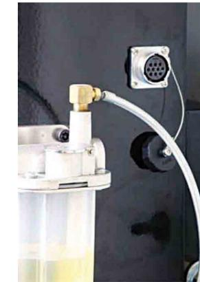
Prise 4<sup>e</sup> axe + graissage centralisé
