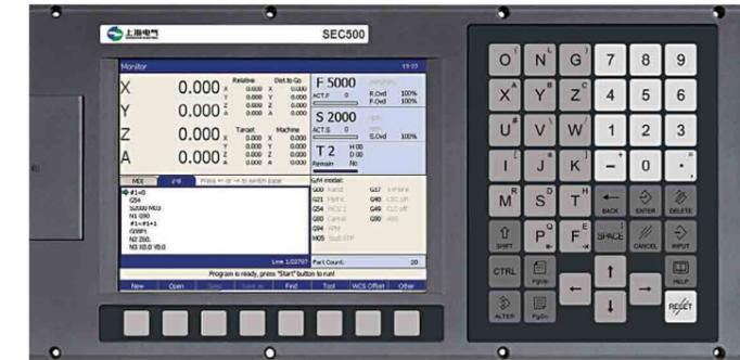
Développé par Shanghai Electric Corporation et basé sur le langage ISO FANUC. La plupart des cycles fixes sont disponibles et notamment le taraudage rigide avec indexation de broche et la gestion de l'interpolation hélicoïdale. Gestion possible des 4 axes.
