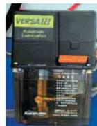
Détail graissage centralisé automatique
