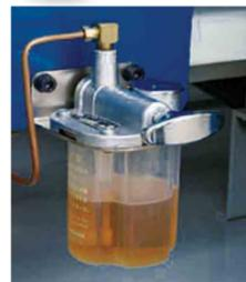
Graissage centralisé manuel des glissières et vis à billes
