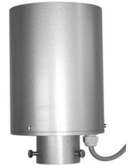
**Pluviomètre à bascule**
