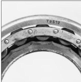
La position de la zone de charge sur la bague considérée résulte du sens des efforts extérieurs agissant sur le roulement et des conditions de rotation. Après une durée de fonctionnement relativement brève, la zone de charge se manifeste par des pistes légèrement ternes, indiquant ainsi si le roulement était correctement chargé.
