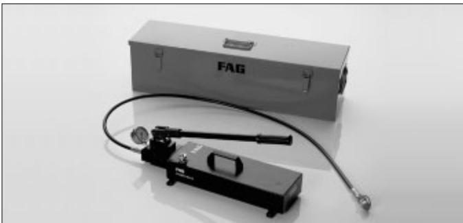
52 : Kit de pompe à main FAG PUMPE1000.4L, comprenant une pompe à double capacité (1000 bar) avec un réservoir d'huile de 4 litres, manomètre, flexible haute pression, raccord fileté ( $G \frac{1}{4}$ ), cofret métallique.
