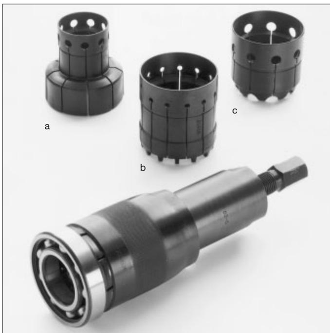
serrage fait partie d'une pince qui est serrée contre la bague intérieure à l'aide d'une bague conique. La force d'extraction est produite par une broche. Ce type d'extracteur permet d'extraire de l'arbre même des roulements encore montés dans le logement. Extracteurs mécaniques FAG, voir la notice N° WL 80-48.
