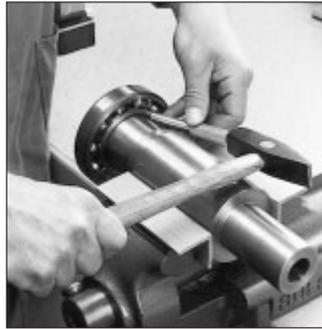
84 : Démontage provisoire d'un roulement par de légers coups de marteau
