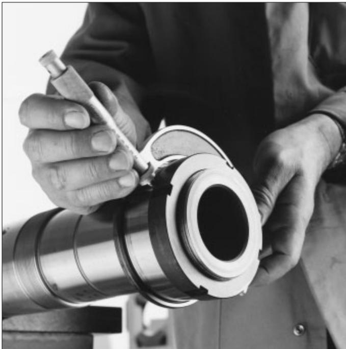
On emmanche le roulement ou le manchon sur la portée conique à l'aide d'un appareillage mécanique ou hydraulique. Le choix du type de montage à adopter dans chaque cas dépend des conditions de montage.
