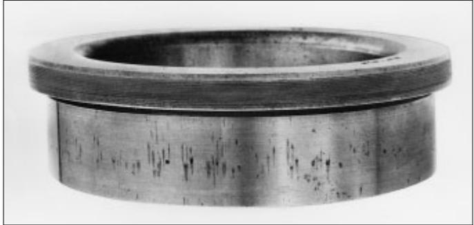
110 : Fatigue prématurée d'une bague extérieure d'un roulement à rouleaux cylindriques précédée par des rayures qu'on peut encore observer en «a».
