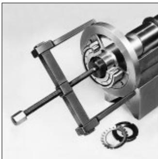
82 : Dispositifs de démontage pour roulements
