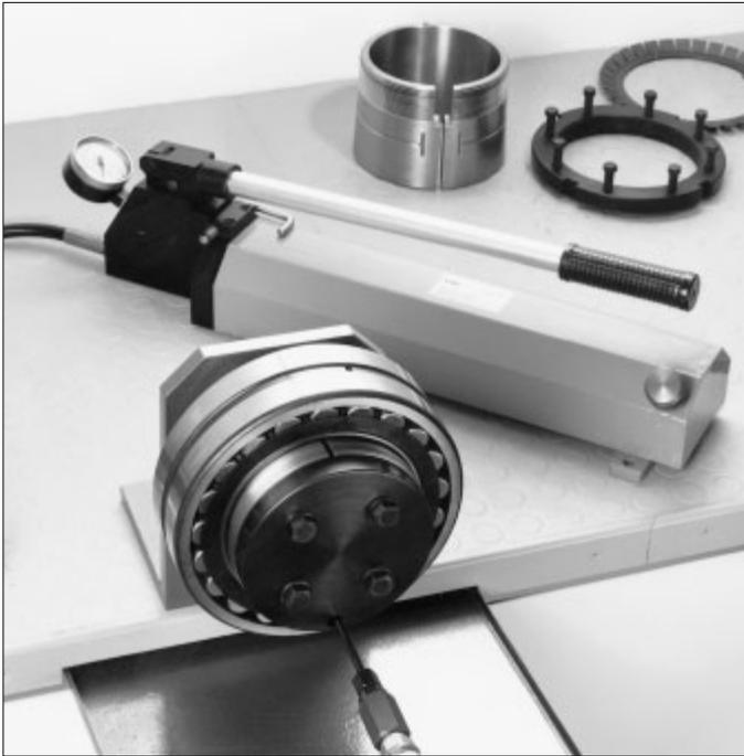
56 : Montage d'un roulement à rotule sur rouleaux à alésage conique selon la méthode hydraulique.
