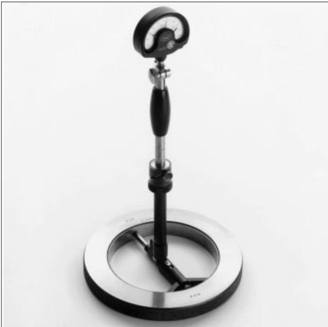
**5: Les instruments travaillant par comparaison se prêtent pour mesurer des alésages. La bague-calibre représentée est utilisée pour l'étalonnage.**
