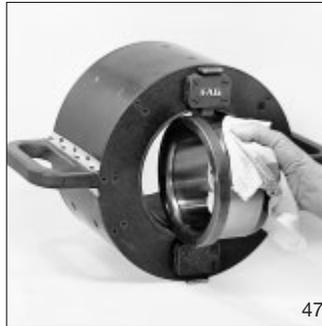
46 : Dispositif de montage pour bas voltages avec transformateur EFB 125/1 pour bagues intérieures de roulements à rouleaux cylindriques avec 635 mm de diamètre d'alésage:
