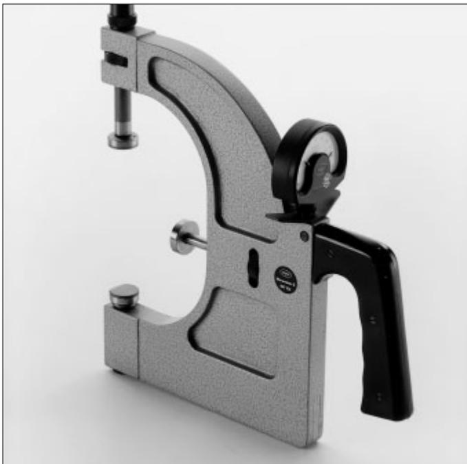
Un autre instrument de mesure est le comparateur spécial conçu par FAG, fig.3. Il permet des mesures comparatives et son réglage est contrôlé au moyen de bagues-calibres. A chaque diamètre à mesurer correspond une bague-calibre également fournie par FAG.
