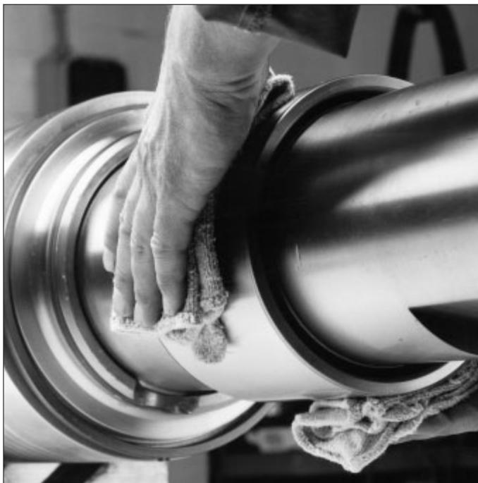
41 : Emmancher les pièces de roulement chauffées rapidement et sans coincement jusqu'à ce qu'elles viennent en butée sur leur portée. Le montage est facilité par un léger mouvement vissant.
